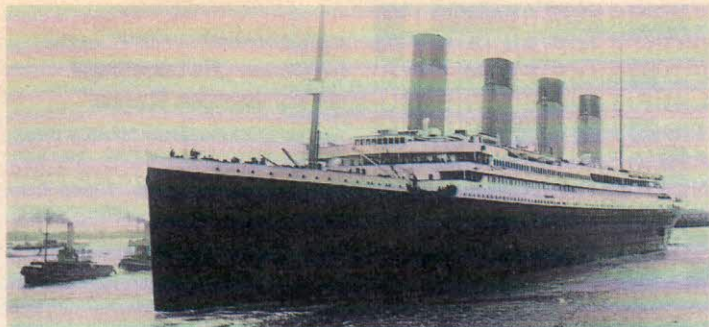
R.M.S. „Titanic“. 46 328 BRT Rauminhalt, 60 000 Tonnen Wasserverdrängung, 46 000 PS mit 29 Kesseln für 22 Knoten (rund 40 km/h), 762 Kabinen in 3 Klassen. Länge: 269 m, Breite: 28 m, Höhe bis zur Brücke: 31,7 m
