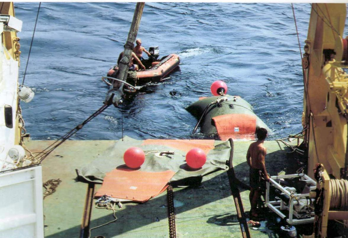
Die grün-roten Liftbags leisten unter Wasser die Arbeit, um schwere Wrackteile an die Meeresoberfläche zu bringen. Sie werden mit Dieselöl gefüllt, das durch sein spezifisches Gewicht, das kleiner als jenes von Wasser ist, für den Auftrieb sorgt.
