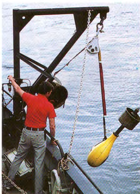
We laten de sonarvis neer die met de geluidsbakens en het sleeptuig communiceert.
