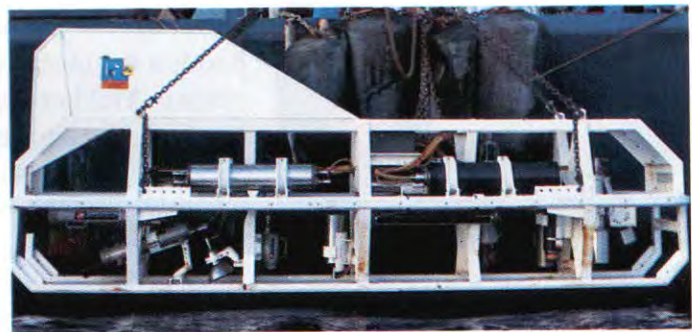
(Rechts) Een foto van de zijkant van de Argo bij afdaling: gewicht 2 ton, lengte 4½ m, hoogte en breedte 1 m.
