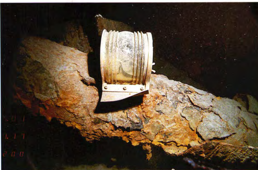
Twee beelden van de bronzen stuurkolom, in 1986 en in 1912. De mechanische stuurinrichting werd hiermee op afstand bediend.
