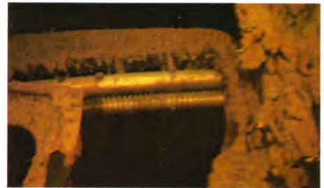
Het nog blinkende wormwiel waarmee de voorste davit van reddingboot nr 2 was neergelaten.
