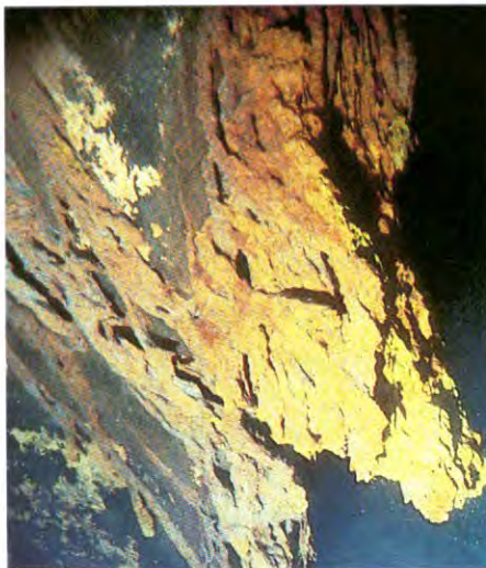
Roestpegels gevormd door ijzeretende bacteriën versieren nu de opening van de kluispijp van het anker op de neus van de boeg.
