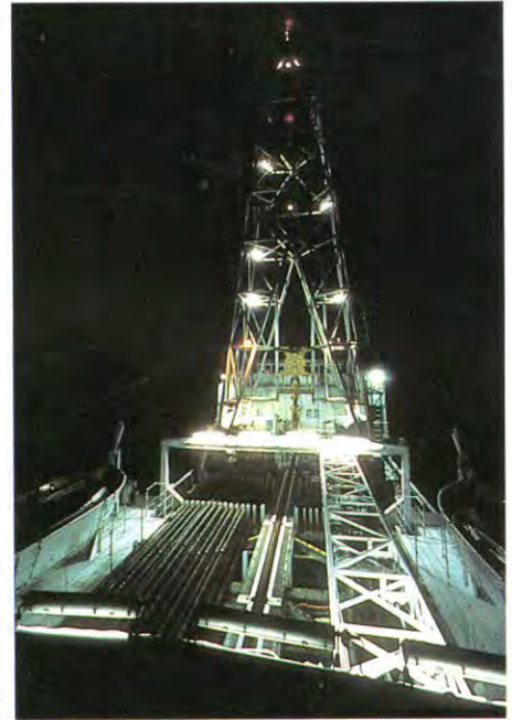
De toren van de Seaprobe bij nacht. Op de voorgrond het laadruim voor 1 km pijp.
