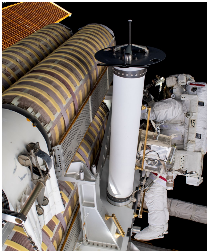
Steve Bowen bevestigt de laatste bouten voor dat de zonnepanelen uitgerold kunnen worden
