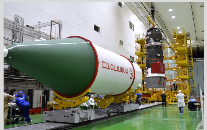
De neuskegel begint aan de inkapseling van de Progress MS-23
